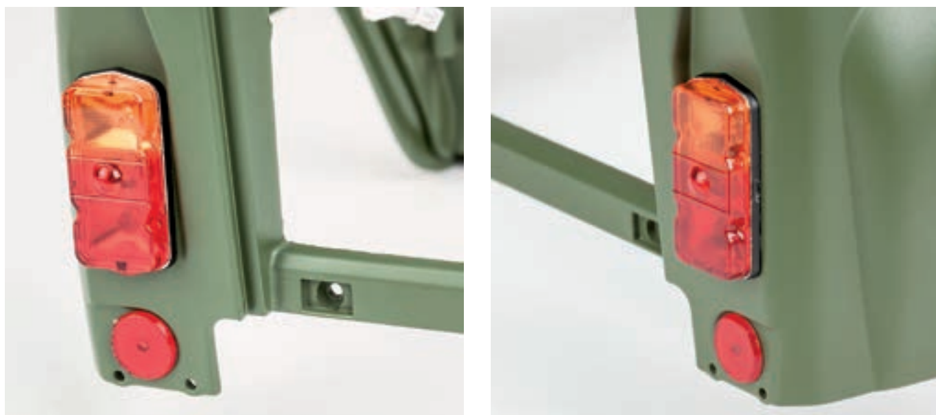
Шаг 6. В отверстиях, расположенных на задних крыльях ниже фонарей, закрепите световозвращатели.
