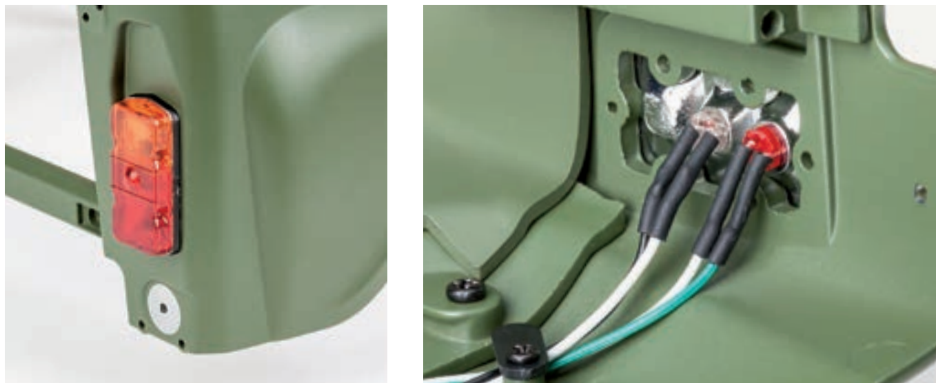
Шаг 5. Закрепите задний фонарь на правом крыле кузова модели. Для облегчения дальнейшей сборки модели отогните ножки светодиодов задних фонарей в сторону внутренней поверхности кузова.
