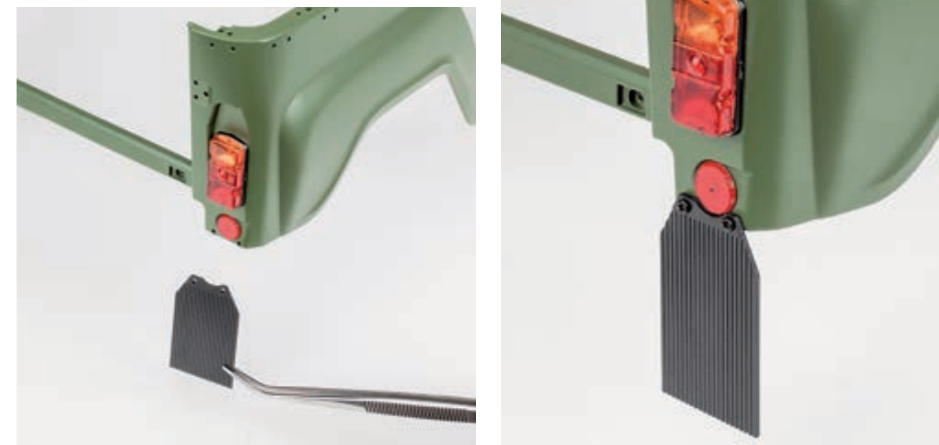
Шаг 8. Аналогичным образом при помощи двух винтов 1,7×4 (СМ) закрепите брызговик заднего правого колеса в нижней части заднего правого крыла модели.
